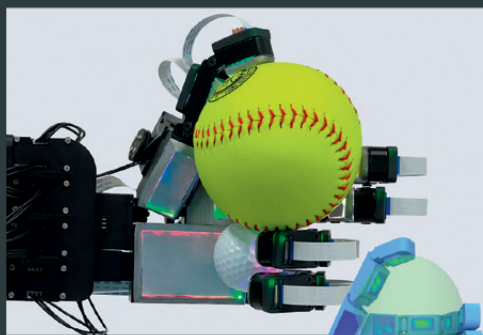
■ 感知区域 ■ 非感知区域 面积(■)/面积(■) ≈ 70% 10000人造触觉感受器/cm 2
